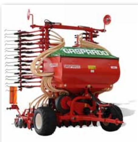
Les fermetures des doseurs sont protégées par un carter afin d'éviter des dysfonctionnements dû à la poussière.
