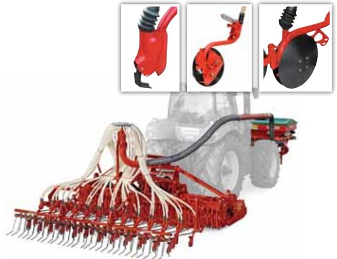
Vous pouvez atteler votre **barre de semis** directement au tracteur ou l'accoupler à une herse rotative. La **trémie frontale PA1** avec une capacité de 1100 litres offre l'avantage d'une répartition idéale de la charge entre l'avant et l'arrière du tracteur sans compromettre la visibilité.
