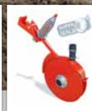
**S MARIA** et **SC MARIA** sont deux semoirs conçus pour le semis en condition difficile ou sur terrain peu préparé. Le châssis robuste et les éléments bien espacés offrent des semoirs adaptés aux conditions de travail difficiles tout en garantissant un entretien minimum. Le semoir **SC MARIA** dispose d'une trémie divisée en deux secteurs, un pour la semence et l'autre pour l'engrais, le dosage est réalisé par 2 boîtes de vitesse indépendantes.
