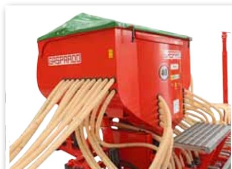
Trémie d'une capacité de 1500 litres : 1000 litres pour la semence et 500 litres pour l'engrais.
