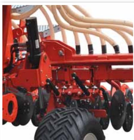
Les vérins de relevage de la barre de semis permettent des manoeuvres en bout de champs faciles et rapides!
