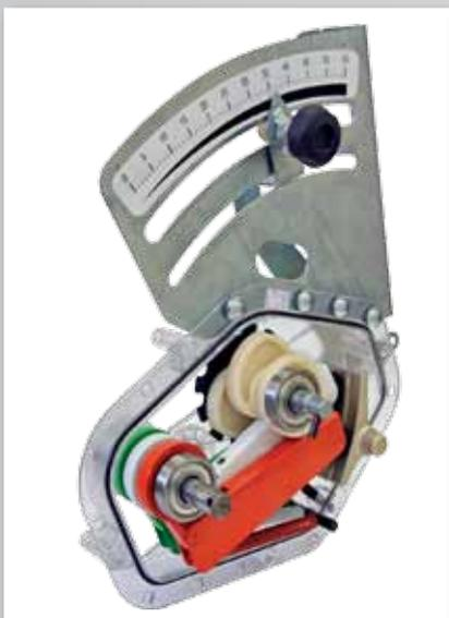
La boîte de vitesse à 3 cames permet un entrainement uniforme et constant. Grâce aux roulements à billes, les cardans seront moins sujets à l'usure. Le boîtier a une lubrification à bain d'huile, avec fenêtre d'inspection; son calibrage est rapide et précis.
