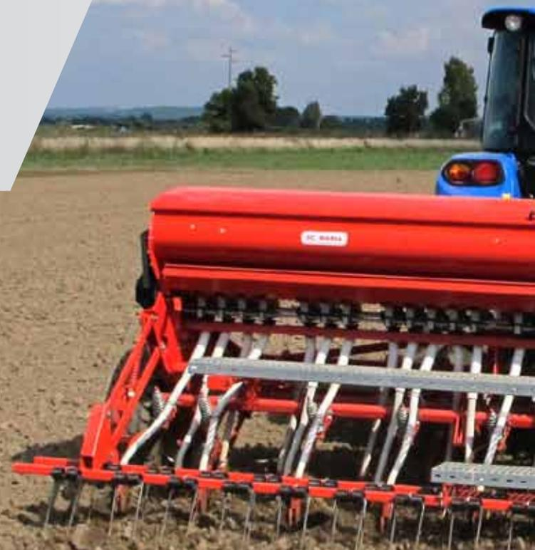
La distribution se compose de différents éléments afin de travailler avec des petites et de grosses graines. Le palpeur à ressort garantit l'intégrité de la graine jusqu'à sa dépose au sol.
