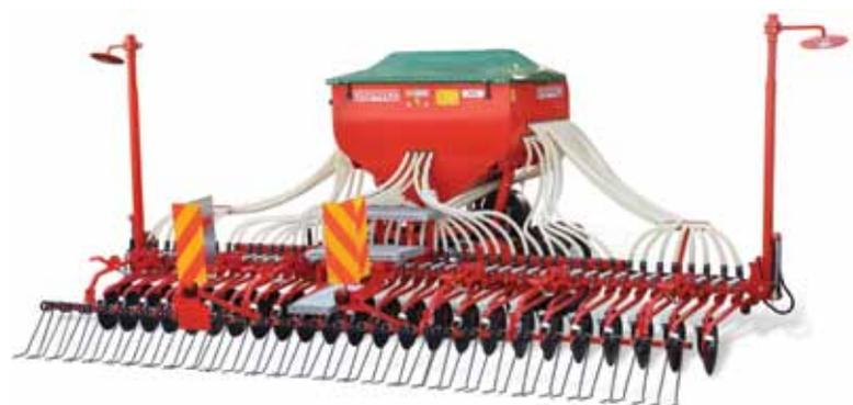
**PINTA 600** est le haut de la gamme avec une largeur de travail de 6m, un châssis renforcé, une trémie de 1500 litres et d'une distribution électrique avec le boîtier **GENIUS LITE**.
