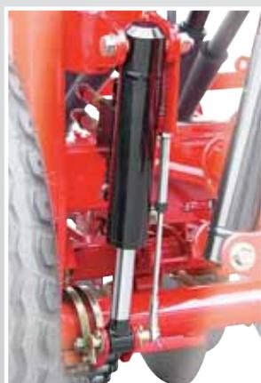
Réglage hydraulique de la pression de la barre de semis.
