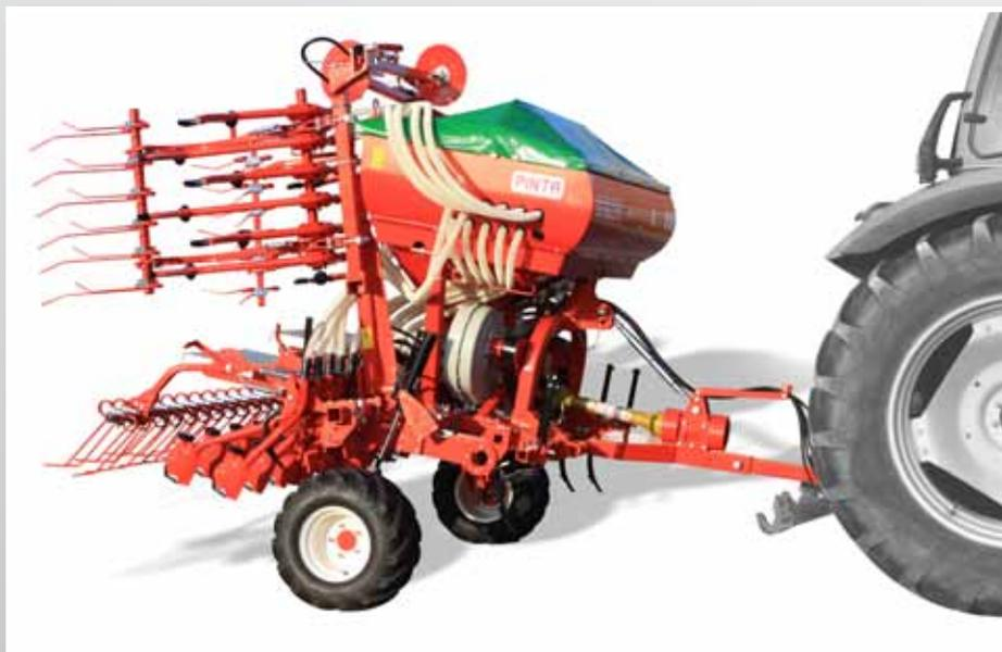
Les semoirs **PINA** et **PINTA** sont disponibles en version portée ou traînée. La version traînée est recommandée pour des terrains vallonnés et est équipée de série des effaces traces et du relavage des roues de transport.
