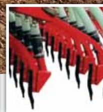
**PRIMAVERA** est le semoir céréales à transport pneumatique dédié au travail simplifié. La gamme inclue des modèles de 4 à 6 mètres à distribution mécanique ou électrique. La trémie de 1500 litres garantit une grande autonomie de travail. Les éléments semeurs à soc ou double disques sont très robustes et disposés sur 4 rangées évitant les phénomènes de bourrage.
