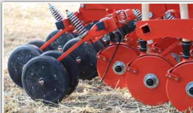
Les éléments semeurs sont portés par un châssis résistant composé de 4 rangés d'éléments permettant de travailler à des vitesses élevées sans avoir de bourrage de résidus. La herse de recouvrement est disponible soit avec des dents droites, des dents courbées ou des roues de tassement.
