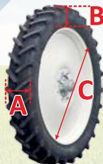
**A= bande de roulement (mm)**
