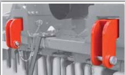
Détail du système de connexion au rouleau sur les modèles **DAMA** et **ALITALIA**. Le poids du semoir est reporté sur le rouleau et non sur la herse : l'avantage principal de cette configuration est de laisser à la herse la liberté de pouvoir osciller vers le haut.
