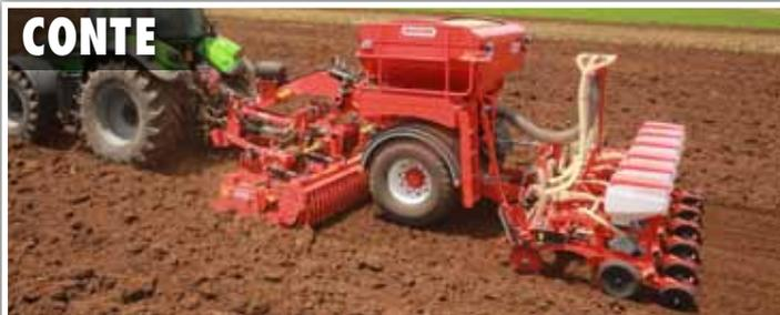
Combiné de semis traîné avec une grande trémie pour l'engrais de 2550 litres et un semoir monograinne de 6 ou 8 rangs (disponible aussi avec 12 rangs écartement 45cm).
