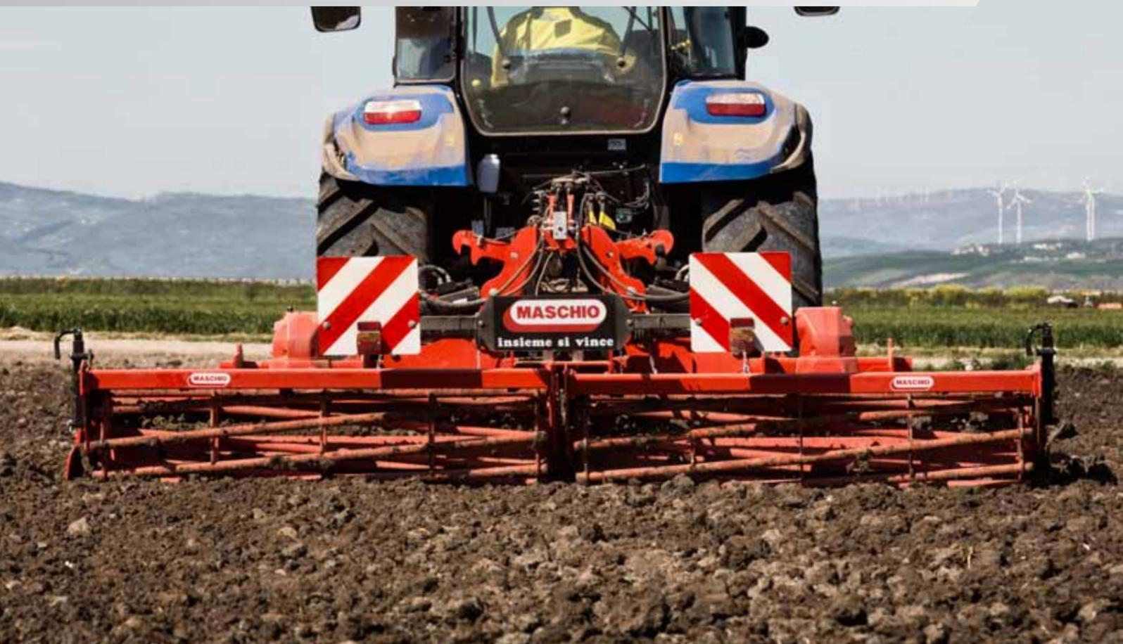
Les modèles **CORVO** et **FALCO** offrent un gabarit routier exceptionnel grâce au repliable compacte de 2,20m. Le modèle **CORVO** se distingue dans la gamme des herse repliables pour son extrême légèreté, il est disponible de 3 à 4m et peut être associé à des tracteur à partir de 90Ch. L'espace entre les deux éléments de la machine réduit (270mm entre les rotors), la faible pression au sol et la barre niveleuse en font le choix idéal pour le travail en rizière.
