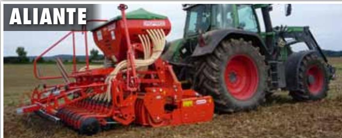
Semoir combiné à distribution pneumatique monté sur la herse pour une répartition parfaite du poids. Avec doseur mécanique.
