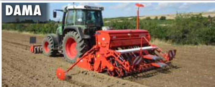
Semoir combiné en ligne avec système de distribution mécanique, simple et léger, il est également disponible avec une transmission électrique.
