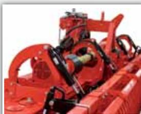
Réglage hydraulique des herse repliables
