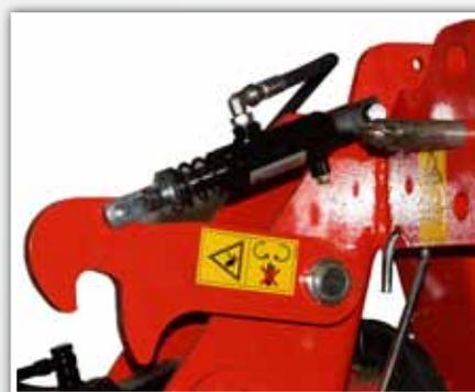
Détail du système de repliage avec sécurité automatique pour le transport (modèle **FALCO**).
