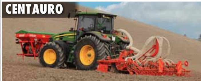
Solution de combiné de semis pour les herse repliables. Trémie frontale de 1260 à 1600 litres, doseur électrique, 1 ou 2 tête de répartition.
