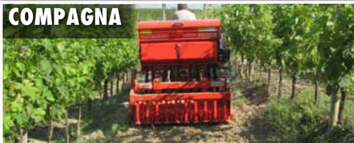
Semoir combiné avec distribution mécanique, léger et économique, il est idéal pour les vignobles et l'enherbement.
