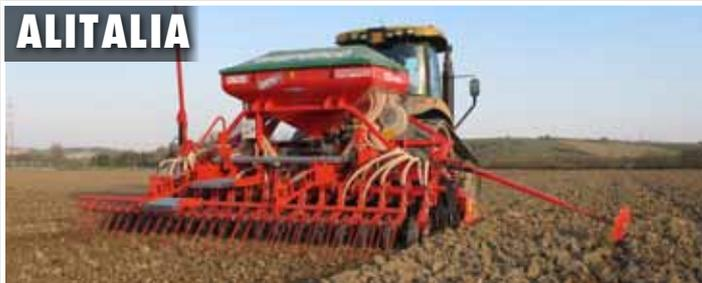
Semoir combiné à distribution pneumatique monté sur le rouleau avec transmission électrique de série.
