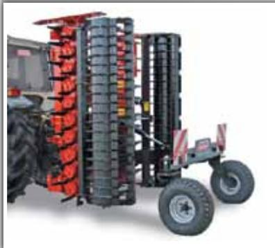
Le système réduit les sollicitations du relavage 3 points pendant la phase de transport en reportant la partie du poids de la machine au sol. Disponibles herse repliables Aquila-Toro-Jumbo.
