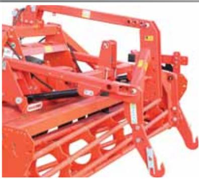
L'attelage hydraulique permet d'atteler sur les herse fixes ou repliable un semoir de céréales ou de précision à l'arrière de la machine. Disponible pour Daino - Drago - Eroe - Dominator - Tarzan - Orso - Aquila (jusqu'à 5 m) -Toro (jusqu'à 5 m).
