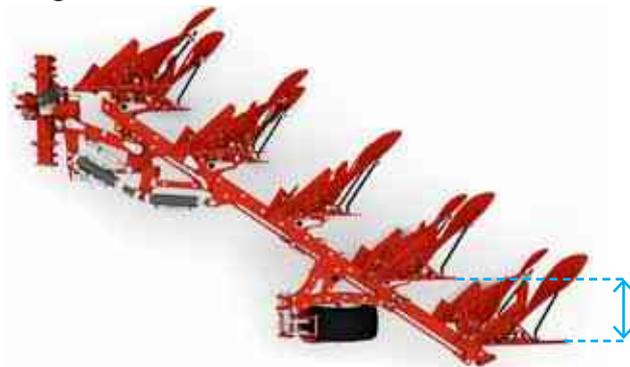
Grâce au système «SmoothSet», le réglage de la largeur de travail ne modifie pas les autres réglages de la charrue.
