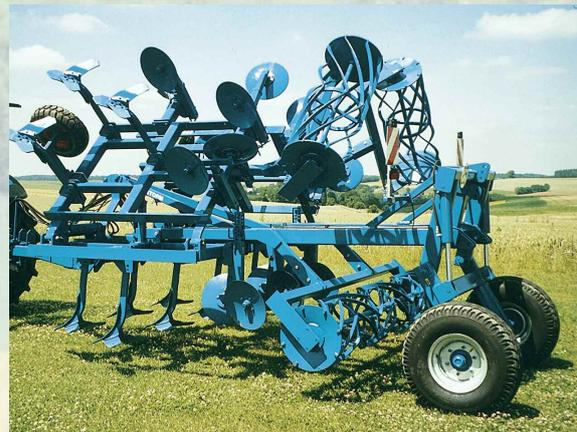
• Appareil semi-porté composé de 2 sections **STORM** 75/380 indépendantes reliées au châssis principal par 2 attelages 3 points. L'adaptabilité des 2 sections d'outils est totale par rapport au relief rencontré. La mise en service de l'outil **STORM** VGX est rapide et permet un gabarit de transport < 3 mètres.
