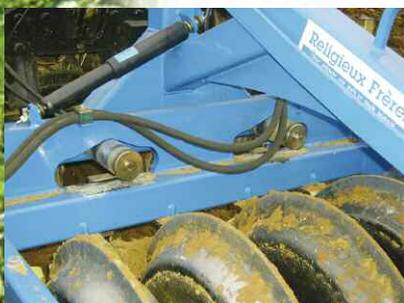
La conduite de l'outil **DEVIL** est très aisée grâce au système d'autoguidage avec 2 vérins amortisseur et compensateur.
