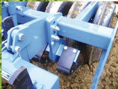
② + ③ Les dents niveleuses (Cross Board) travaillent conjointement avec les disques RING ou ROULOSANGE. Intercalées entre ceux-ci, Elles dirigent les mottes de terre vers le disque droit ou gauche grâce à leur forme courbée à la base et permettent un nivellement précis.
