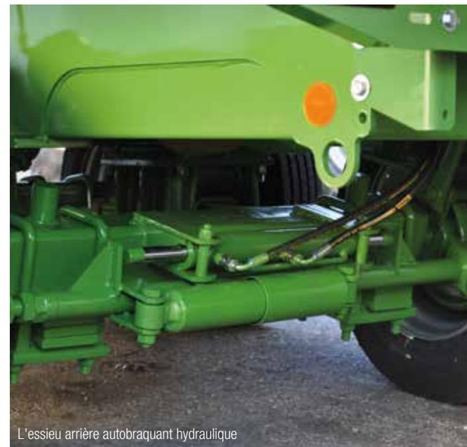
L'essieu arrière autobraquant hydraulique
