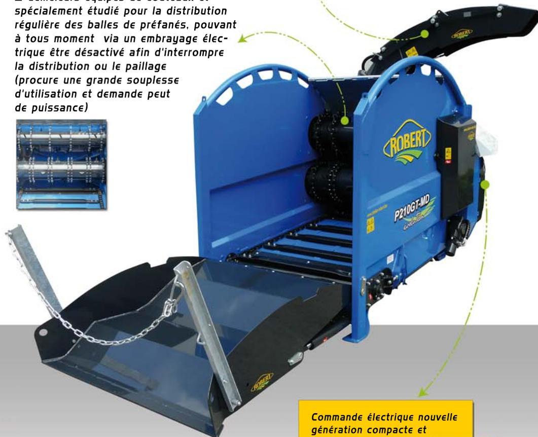
Commande électrique nouvelle génération compacte et intuitive (de série)
