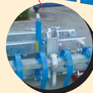
Manivelle de réglage permettant d'ajuster la profondeur et l'agressivité des palettes suivant le travail à effectuer.
