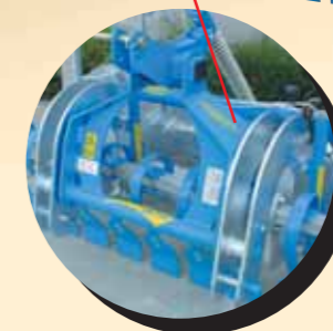
Ressort compensateur reliant le triangle 3 points au châssis ayant pour effet d'absorber les inégalités du terrain.
