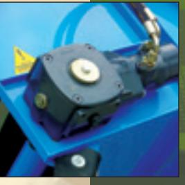
► Commande du tapis, par moteur hydraulique équipé d'un variateur de vitesse, indépendante du démêleur. Cette solution technique offre l'avantage de pouvoir diminuer ou augmenter la vitesse du tapis indépendamment de celle du démêleur (distribution d'ensilage d'herbes)
