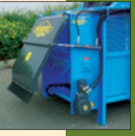
► Porte de distribution à commande hydraulique indépendante. En position fermée pour le transport elle élimine tous risques de perte. En position ouverte pour la distribution, elle canalise l'ensilage vers les auges
