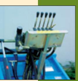
► Distributeur hydraulique à commande manuelle (électrique ou téléflexible en option) monté sur un support réglable et facilement accessible du poste de conduite regroupant toutes les fonctions de la machine
