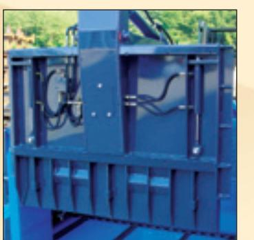
► Tôle rétractable commandée avec 2 vérins hydrauliques permettant de ramasser impeccablement le pied des silos de maïs, pulpes, etc et aussi de racler complètement le fond de la machine. Se monte sur la H-1800 et la H-2800
