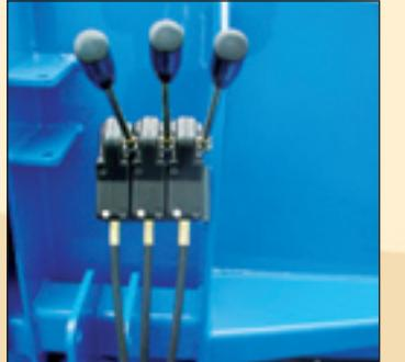
► Commandes par téléflexibles à installer dans la cabine offrant la possibilité de travailler toutes vitres fermées.
