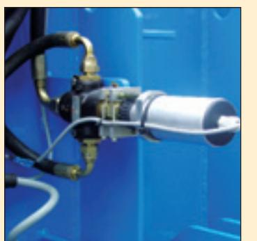
► Réglage à distance de la vitesse du tapis par moteur électrique.
