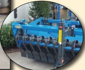
> Palettes racleuses escamotables montées sur dents flexibles. Pression de travail réglable par 2 vérins DE ( uniquement sur mod. BA)
