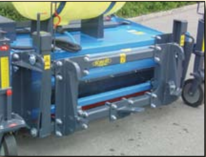
> Attelage oscillant pour suivre parfaitement la surface à balayer indépendamment du chargeur (pour modèle BR).
