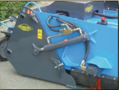
> Ouverture du bac récolteur avec 2 vérins (DE) équipés de clapet anti-retour.
