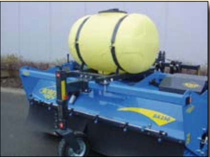
> Système d'arrosage sous pression avec pompe électrique (réserve d'eau 400 litres).
