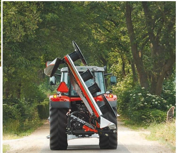
Pour la stabilité, en position de transport, l'inclinaison à  $120^\circ$  de la machine assure une meilleure répartition du poids au niveau de l'essieu arrière. La sécurité et le confort de transport s'en trouvent nettement améliorés. Les feux du tracteur restent par ailleurs bien visibles. La nouvelle forme du châssis intermédiaire permet une faible hauteur de transport (3,6 m avec un dégagement de 40 cm). En position de travail à distance normale du sol, le dégagement est de 50 cm.
