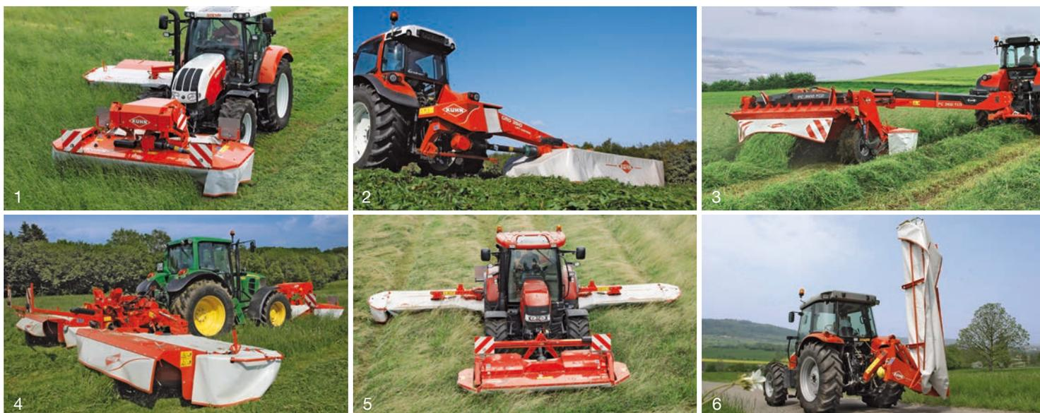
1. Faucheuses-conditionneuses à disques portées frontales - 2. Faucheuses à disques à repliage horizontal - 3. Faucheuses-conditionneuses à disques traînées - 4. Faucheuses-conditionneuses à disques triples - 5. Faucheuses à disques triples - 6. Faucheuses à disques à repliage vertical.
