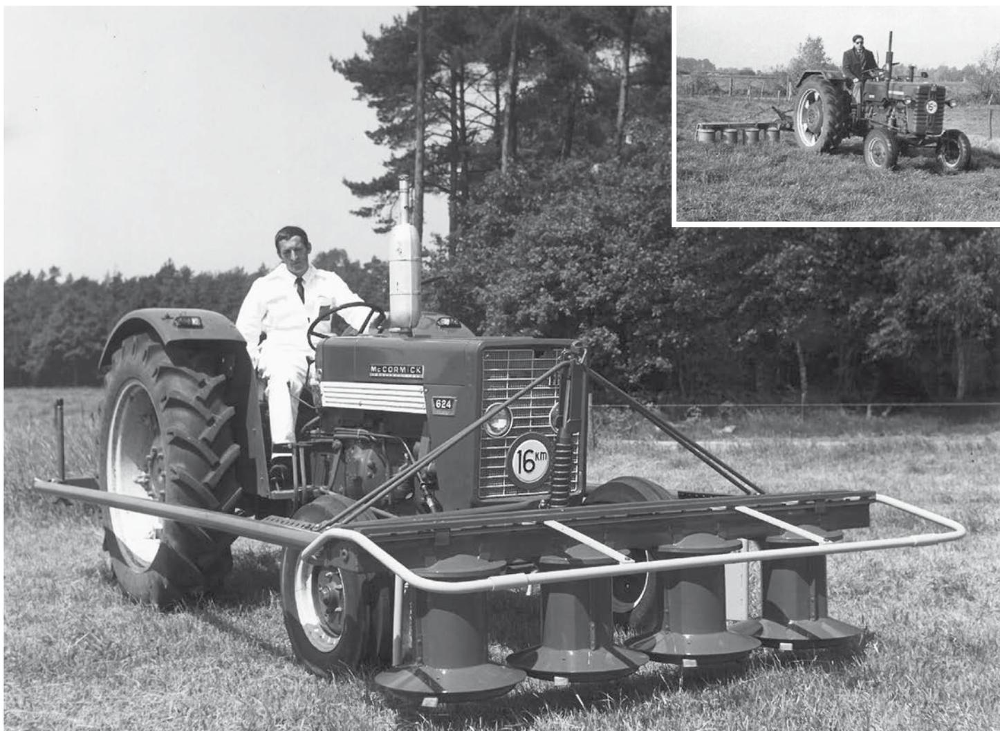
Vers 1970, Piet Zweegers inventa également la faucheuse frontale en créant un système qui permettait d'atteler la machine à l'avant du tracteur tout en conservant un entraînement depuis l'arrière de celui-ci.
