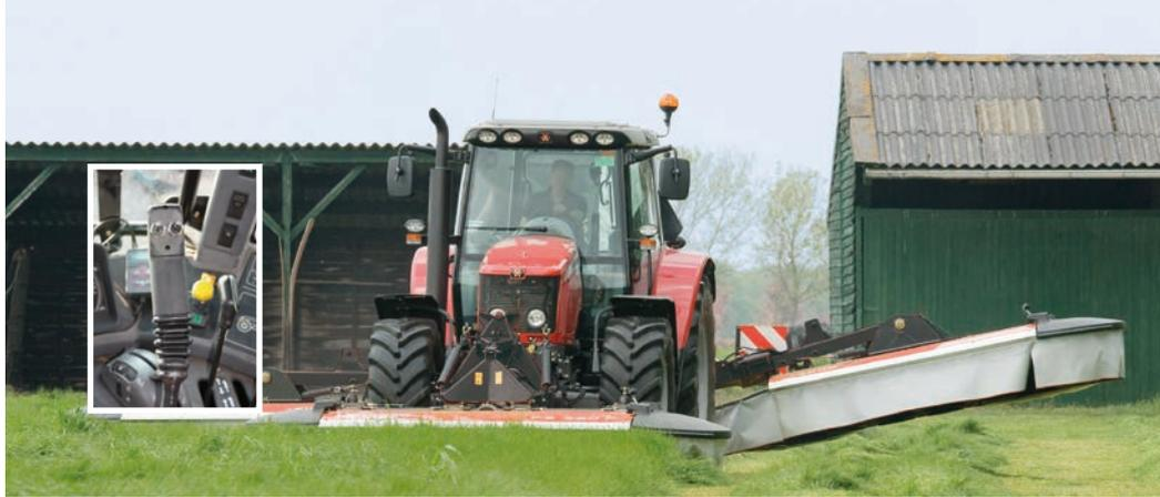
Relevage indépendant. La faucheuse à tambours PZ 960 est dotée, de série, d'une commande hydraulique multifonction.
