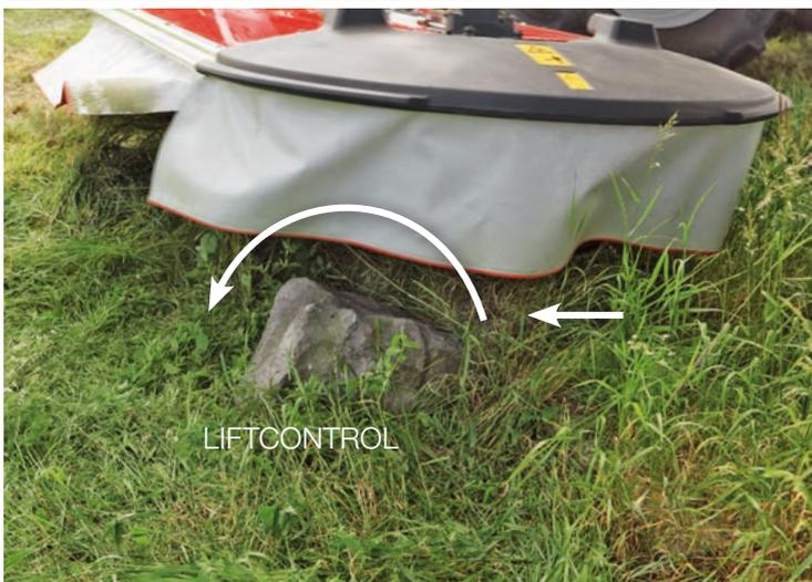
En cas de collision avec un obstacle, le groupe de fauche pivote vers l'arrière puis se soulève grâce au système oléopneumatique LIFT-CONTROL. Le point d'articulation de la faucheuse se situe sur la gauche du tracteur et non au milieu. Cette conception assure une protection optimale des tambours (même de ceux les plus proches du point d'articulation grâce à l'espace supplémentaire entre le point d'articulation et le premier tambour).
