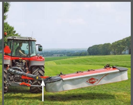
Suffisamment bas lors du transport et suffisamment haut en position de travail et relevée, le châssis intermédiaire offre toujours une hauteur optimale, quelle que soit la position.
