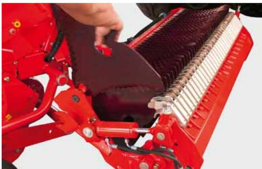
Grâce au déverrouillage centralisé, les couteaux sont automatiquement libérés et peuvent être retirés sans outil.
