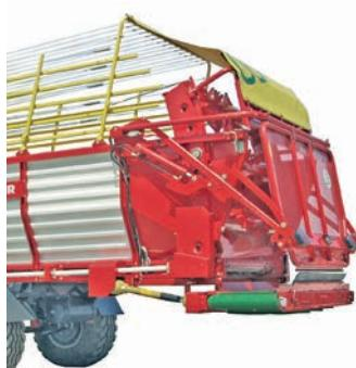
Un tapis de fourrage régulièrement réparti représente la condition essentielle pour un tassemant optimum du silo. Le dispositif à 3 rouleaux doseurs facilite le travail du chauffeur et soulage la machine. De série avec le terminal POWER CONTROL, compatible ISOBUS.
