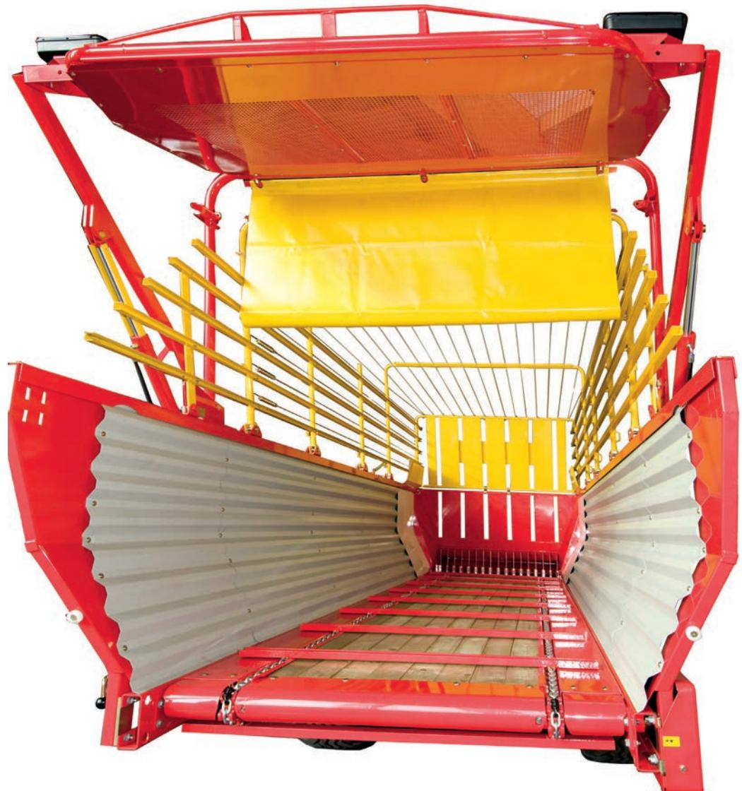
La porte arrière s'ouvre de série hydrauliquement depuis le siège du tracteur. L'effacement total de la porte permet un déchargement rapide et sans obstacle.
