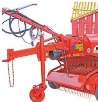
Le timon hydraulique (en option), conférant un dégagement sous pick-up de 60 cm, permet de rouler sans problèmes sur le silo et sur terrains accidentés.
