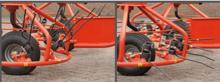
Fourches actionnées par la force centrifuge
