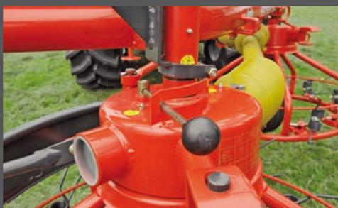
Levier permettant d'inverser le sens de rotation du rotor et pictogramme explicatif. (Haybob 360)
