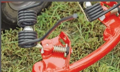
Position des fourches pour le fanage : orientées vers l'avant. (Haybob 300 et 360)
