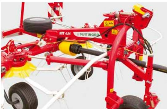
**Ces faneuses, avec des largeurs de travail (DIN) de 4,40 m et 5,20 m, sont particulièrement compactes et parfaitement adaptées aux terrains en pentes. 6 bras par toupies garantissent un fanage optimal dans chaque type de fourrage.**
