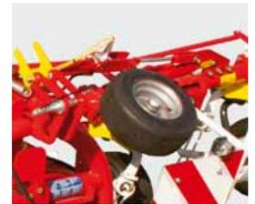
**Fanage de bordure centralisé hydraulique**
