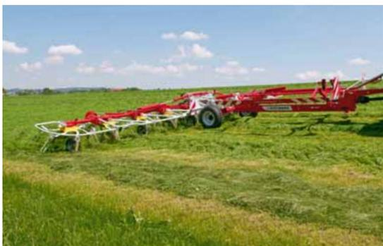
**Les faneuses traînées HIT T avec dix ou douze toupies sont conçues pour de très grosses surfaces. Afin de répondre à la demande pour de grandes largeurs de travail avec un suivi parfait du terrain, les toupies sont montées individuellement sur articulations. En combinaison avec la fonction de guidage assurée par le chariot de transport, les HIT T garantissent un travail parfait, même à vitesse d'avancement élevée.**
