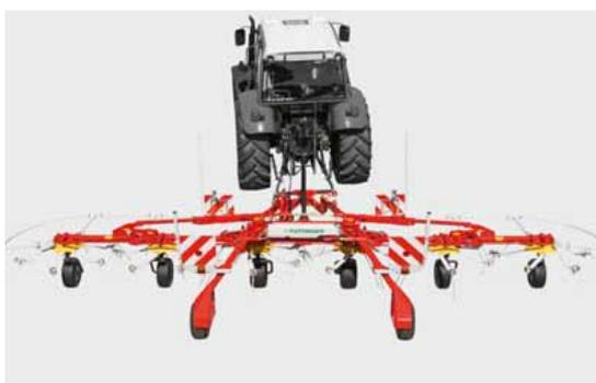
L'HYDROLIFT est de série. Il permet de relever les toupies extérieures et simultanément l'ensemble de la machine lors de manoeuvres en bout de champ
