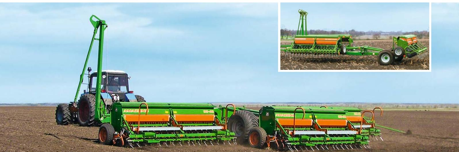
équipé d'une commande de jalonnage qui peut réaliser des cadances de jalonnage de 12 m, 24 m ou 36 m. Les machines latérales sont repliées pour les déplacements sur route. En position repliée, la largeur au transport est d'environ 6 m. Au total, deux distributeurs seulement sont nécessaires sur le tracteur. Les trois D9 Super peuvent également être utilisés séparément.
