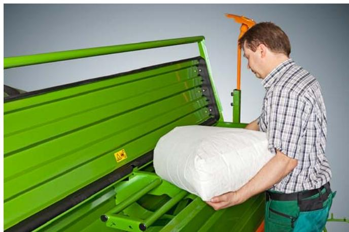
Le système d'aide au chargement facilite le remplissage par sacs de la trémie.
