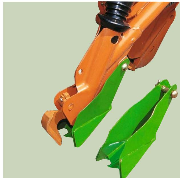
Les **sabots de semis en bande** sont faciles à installer et permettent de répartir la semence en bandes et de réduire la profondeur d'implantation.
