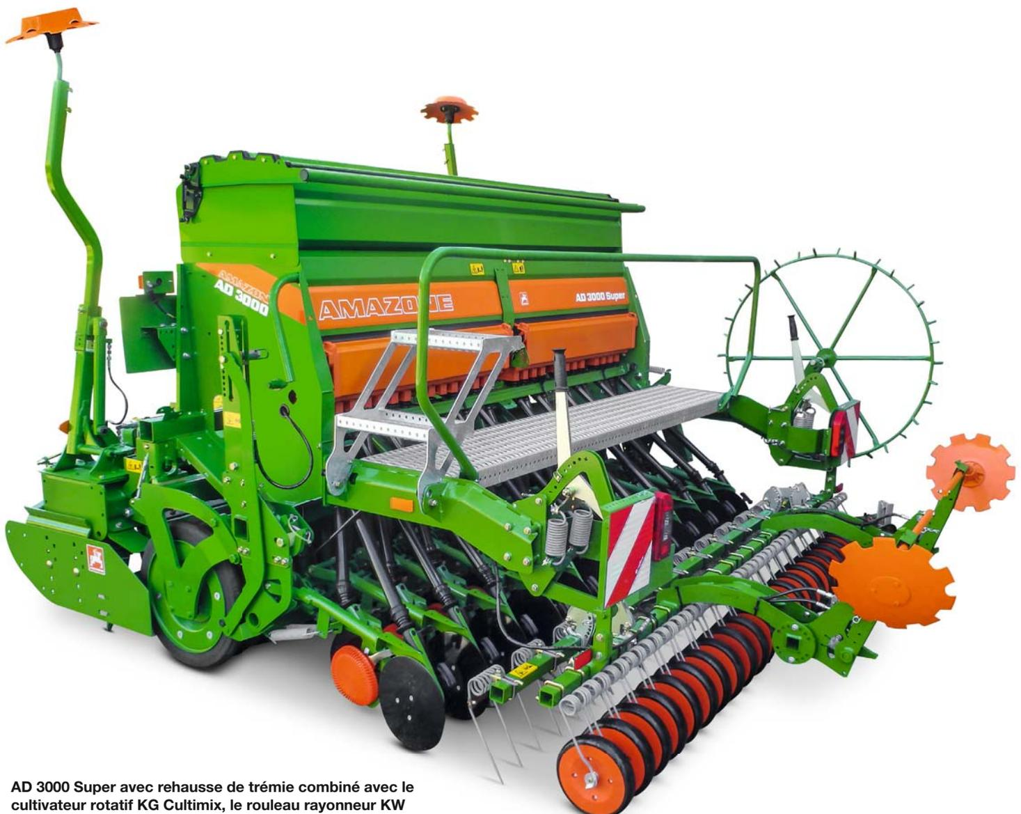
AD 3000 Super avec rehausse de trémie combiné avec le cultivateur rotatif KG Cultimix, le rouleau rayonneur KW Matrix, les RoTeC Control et le recouvreur Tassaprés®.
