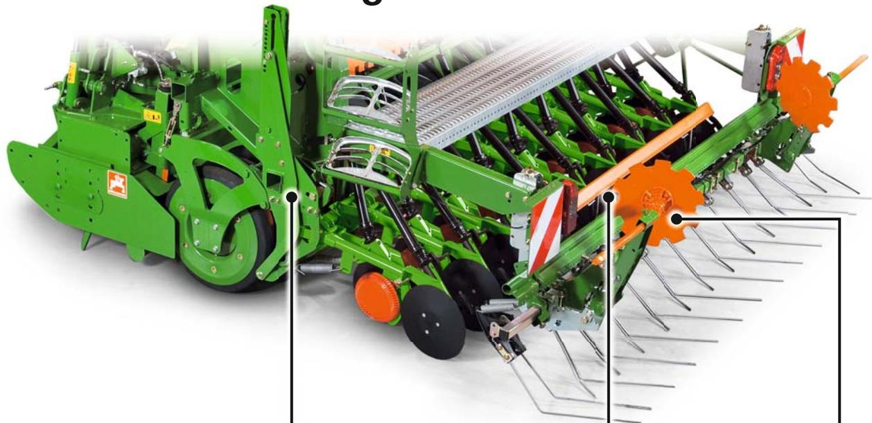
Réglage hydraulique centralisé de la pression des RoTeC
