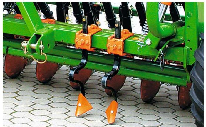
Les semoirs portés utilisés en solo peuvent être équipés d'efface-traces qui referment par l'extérieur la trace du tracteur. AMAZONE propose pour les sols très pierreux, des efface-traces avec sécurités spéciales.
