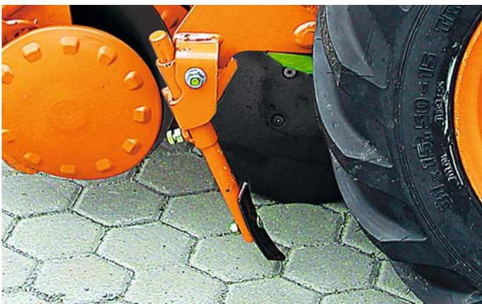
Les traces de roues au sol peuvent être effacées par un efface-traces, intégrant une sécurité anti-pierres, devant le soc extérieur.
