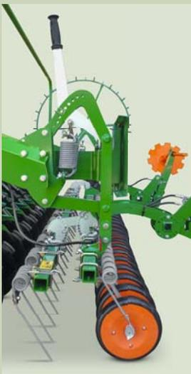
Le recouvreur FlexiDoigts est réglé en continu par le biais de broches. Le réglage central du recouvreur Tassaprès® est réalisé par un réglage intégrant une sécurité de surcharge. Ainsi l'intensité de la pression de rappui du recouvreur se règle de façon très souple ou les recouvreurs Tassaprès® peuvent être mis hors fonction. Ainsi par exemple les recouvreurs Tassaprès® peuvent être com-
