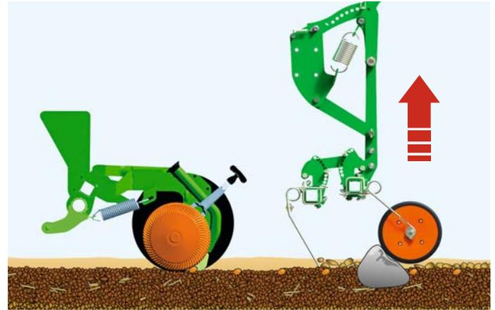
En cas de choc sur une pierre, le RoTeC Control se lève qu'une seule fois. Sur les autres systèmes avec maintien rigide sur parallélogramme, l'escamotage de l'élément de mise en terre se décompose en deux fois.
