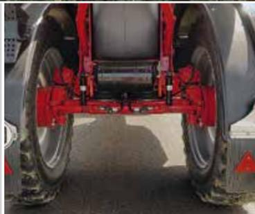
Garde au sol élevée et carénage lisse avec essieu suspendu, suspension à coussin d'air en option
