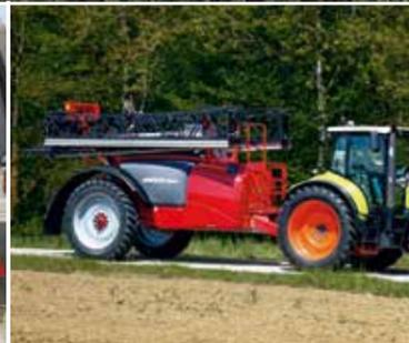
Pas de rampe au-dessus de la cabine du tracteur
