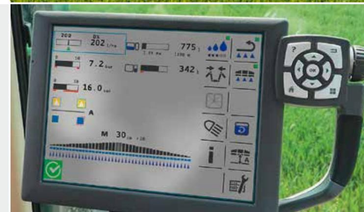
Le pilotage du Leeb LT est possible avec différents terminaux ISOBUS et avec le joystick ou la poignée multi-fonctions du tracteur.
