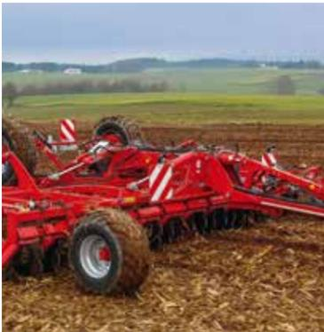
Roues de contrôle de profondeur
