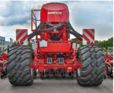
Option : pneumatiques 710/50–26.5 pour la préservation des fourrières lors des demi-tours
