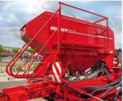
Trémie à double cuve de 5 000 litres, répartition 40 : 60
