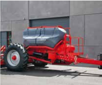
Pneumatiques de grande dimensions : 520/85 R38
