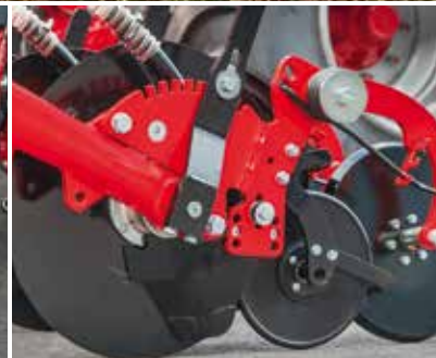
Réglage fin par paliers de la profondeur de semis
