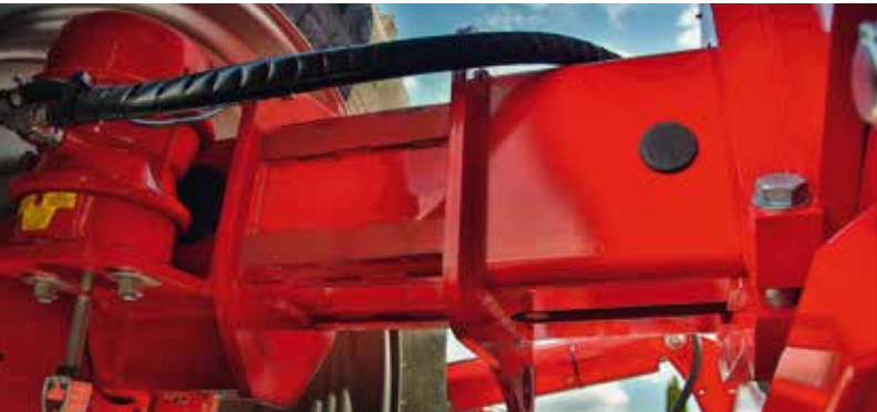
Essieu télescopique de série : largeur de transport compacte, réduction de la compaction derrière les roues du tracteur
