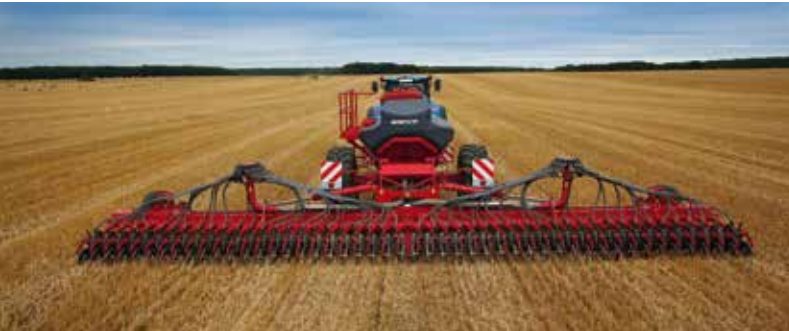
Transfert de charge hydraulique de la remorque semoir sur le châssis semeur : Pression sur les éléments semeurs répartie de façon homogène sur toute la largeur de travail.
