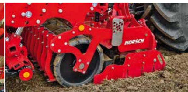
**Rouleau packer Trapeze** pour un ré-appui ciblé en bandes pour conditions difficiles et collantes (Ø 50 cm et 60 cm)
