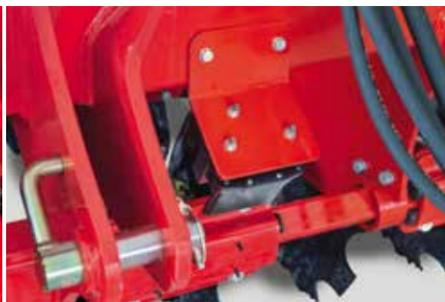
**Capteur radar** pour une lecture exacte de la vitesse d'avancement et la régulation de la quantité de semence.
