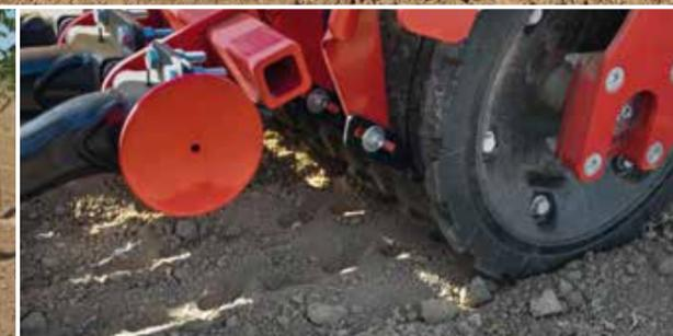
Packer FarmFlex de 54 cm de diamètre pour un ré-appui en bande et une adaptation à tous les types de sol.
