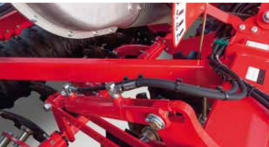
**Réglage hydraulique de profondeur du DiscSystem**
