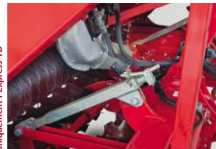
**Réglage de la profondeur du DiscSystem par deux manivelles.** En option, deux vérins hydrauliques permettent de varier la profondeur en cours de travail.
