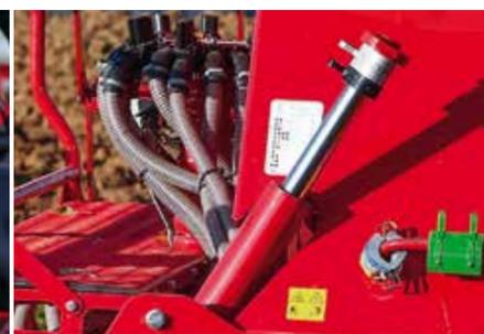
**Réglage hydraulique de la profondeur de semis avec clips alu**
