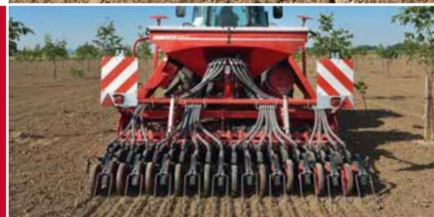
Trémie d'une capacité de 1 500 litres.
