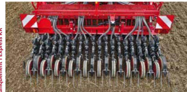
Position optimale des éléments semeurs derrière le rouleau en bandes. Chaque élément semeur évolue exactement là où une bande de ré-appui est plus prononcée.
