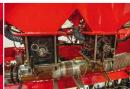
**Version double cuve avec le système Grain & Fertilizer** (45:55)
