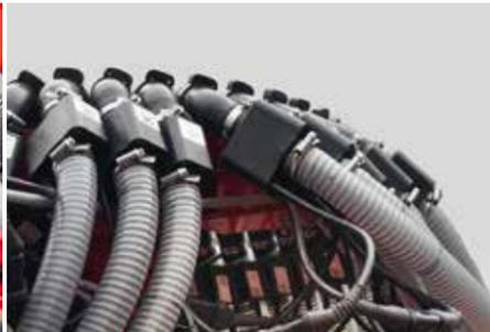
**Capteurs de contrôle du flux de semences résistants**
