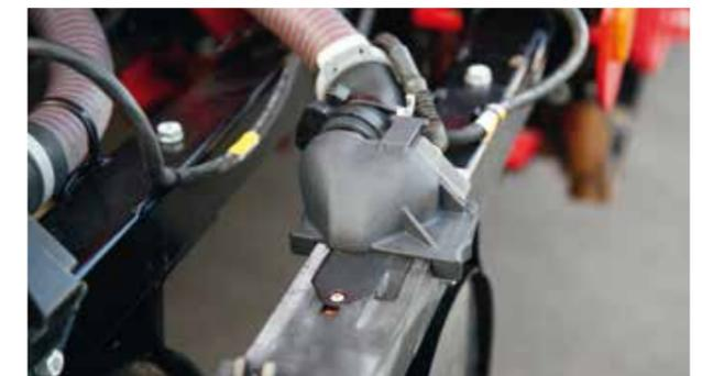
Système Bypass pour semis avec une densité supérieure à 250 gr/m<sup>2</sup> ou pour semences inadaptées à la sélection graine à graine
