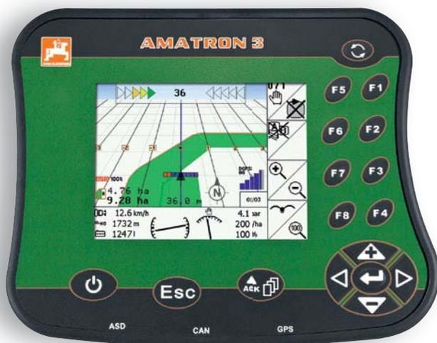
L'AMATRON 3 permet une régulation entièrement automatique du débit demandé (l/ha). Les modifications de débit sont réalisées rapidement et avec précision en paliers présélectionnés exprimés en %.
