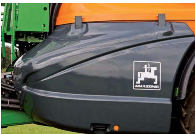
Tous les éléments de commande sont logés de façon centrale à l'avant sous un capot de protection. Ce capot permet de réduire l'encrassement des robinets et offre une très bonne accessibilité pour une maintenance rapide et efficace.
