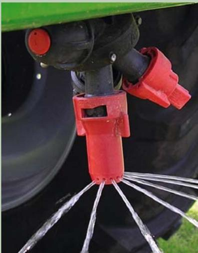
AMAZONE propose pour la fertilisation liquide des buses multi trous permettant une répartition de grosses gouttelettes.
