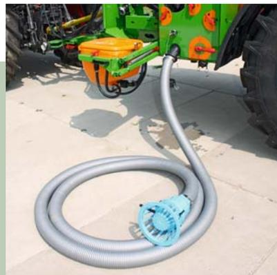
Remplissage au moyen d'un flexible d'aspiration
