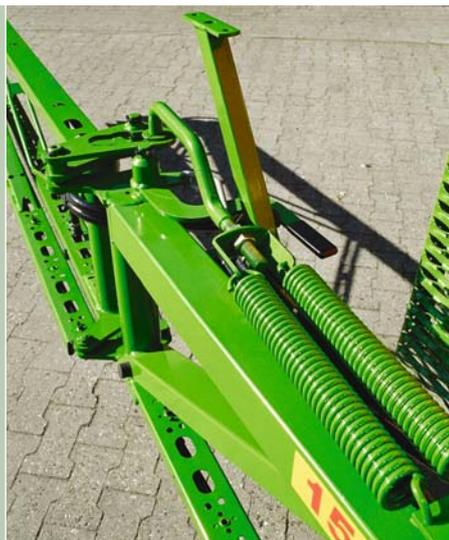
Rampe Q-plus à repliage manuel
