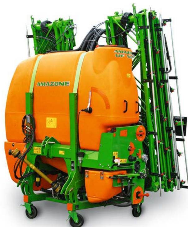
UF 1201 avec 24 m de rampe de pulvérisation Super S et roulettes de manutention (freiné)
