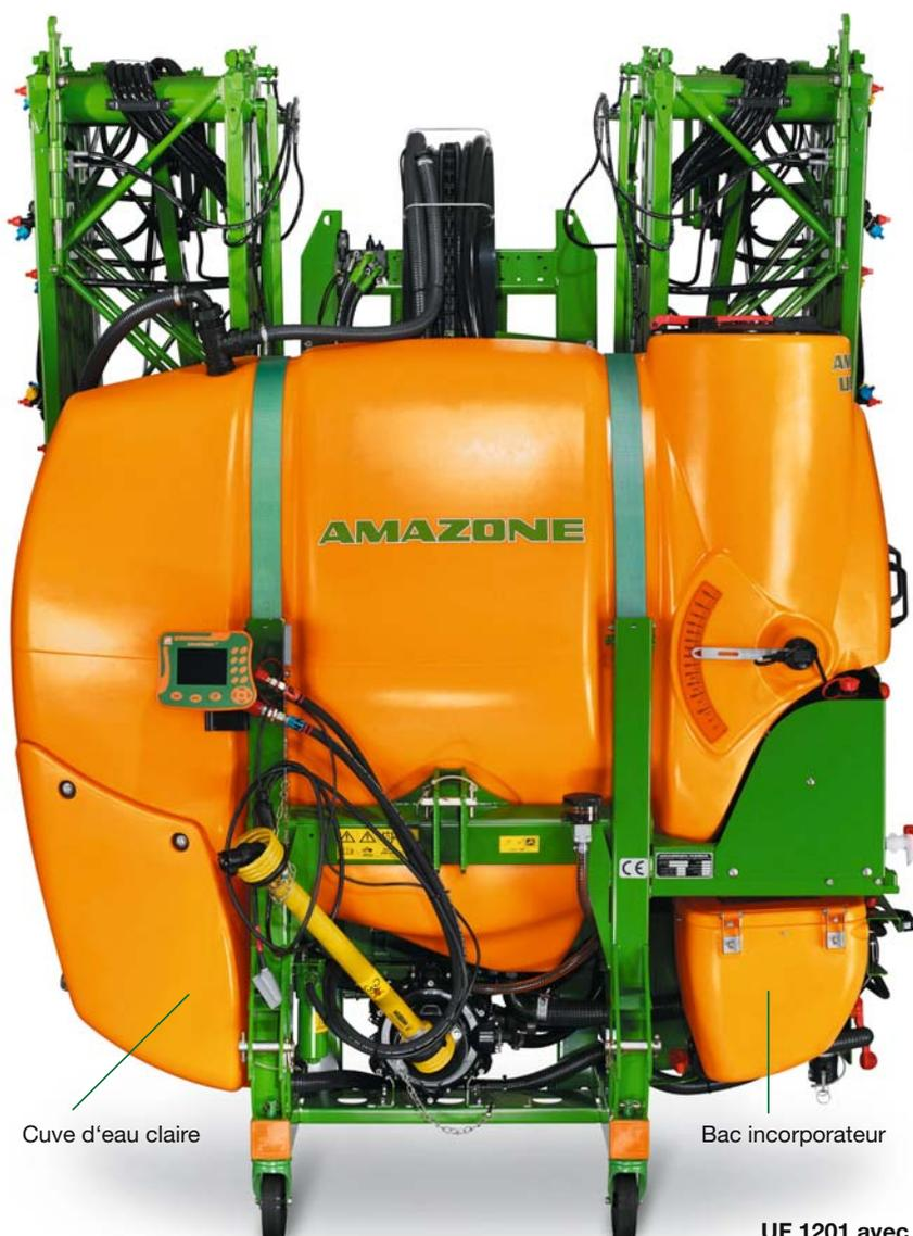
La cuve d'eau claire contenant 120 litres (901/1201) ou 180 litres (1501/1801) se trouve sous la cuve à bouillie. Le remplissage simple, au niveau du sol, est permis grâce à un bon positionnement dans le sens de la marche, à droite. Sur demande, la cuve d'eau claire peut également être remplie via un raccord de remplissage sous pression dans le sens de la marche, à gauche.
