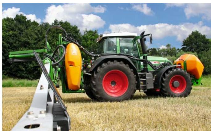
La cuve frontale permet d'augmenter le volume de bouillie embarqué et sert également de lestage frontal.
