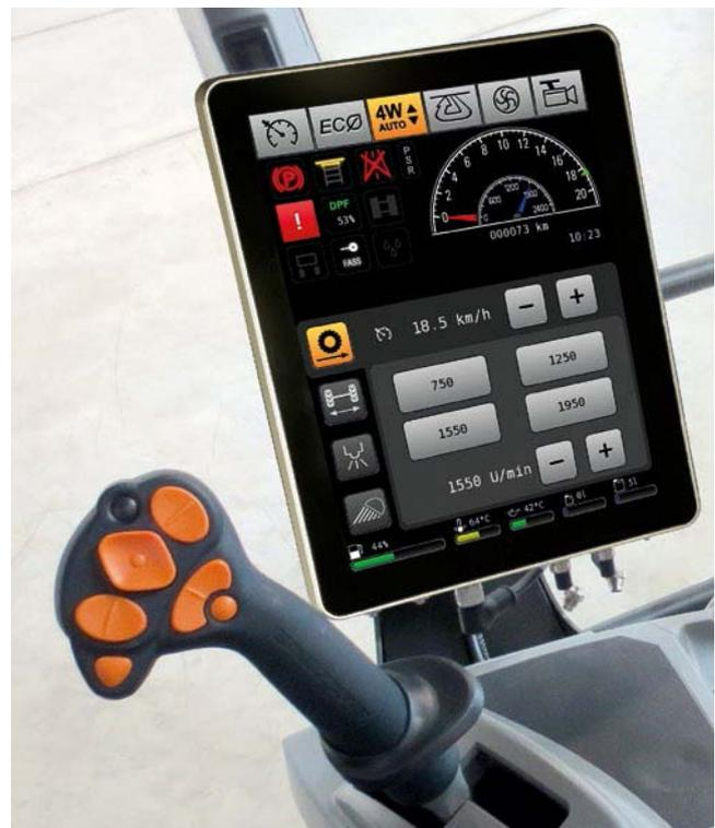
⊕ « La nouvelle poignée multifonction Amapilot nous a également beaucoup plu, elle intègre en plus des fonctions de vitesses de déplacement et de régulation de vitesse, également les fonctions de pulvérisation les plus importantes (largeurs partielles et rampe, commutation de buse de bordure et adaptation du débit). »
