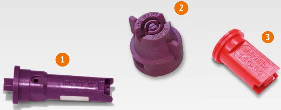
Les buses à injection d'air (ID, TTI) ont un spectre de gouttelettes relativement grossier et sont particulièrement variables du point de vue plage d'application. Une plage de pression de 2 à 8 bars est possible.
