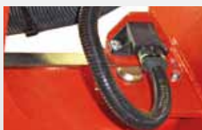
Capteur angulaire sur parallélogramme
