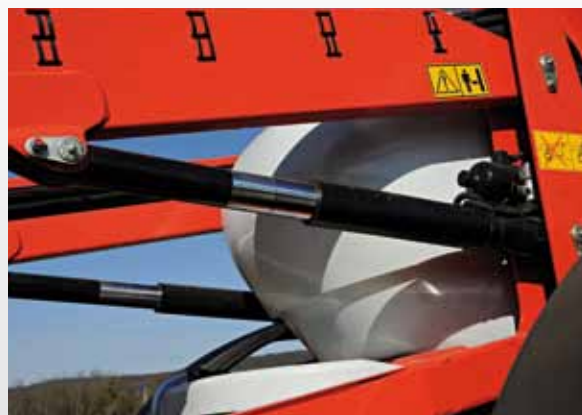
Vérin du parallélogramme équipé d'une boule d'azote de suspension
