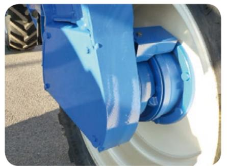
Moteur hydraulique sur pont avant
