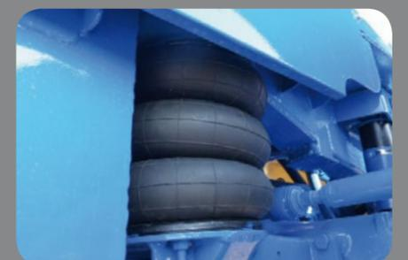
50 % de suspension en plus ! Suspension renforcée sur le pont arrière : les poumons ne comportent plus 2 mais 3 étages
