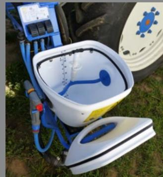
Pour rincer les bidons et le cône, les vannes de commande sont positionnées sur le support de l'incorporateur.
