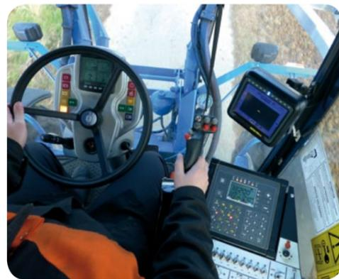
Maîtrise rapide de la pulvérisation : pupitre de commande ergonomique, boîtier de régulation et barre de guidage à portée de main.
