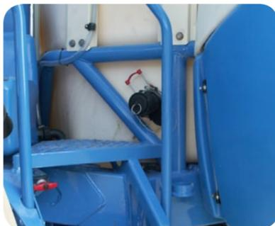
Pour ceux qui disposent d'une pompe à l'exploitation et qui souhaitent remplir leurs cuves directement : orifices de remplissage direct sur cuves principale et de rinçage.
