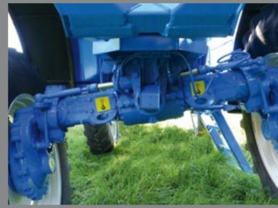
Localisés de part et d'autre du pont AR, des vérins commandent automatiquement les mouvements de l'automoteur : un premier contrôle la position du châssis, un second rectifie celle des rampes.
