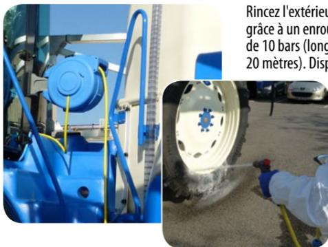
Rincez l'extérieur de l'appareil grâce à un enrouleur avec lance de 10 bars (longueur du tuyau 20 mètres). Disponible en option.
