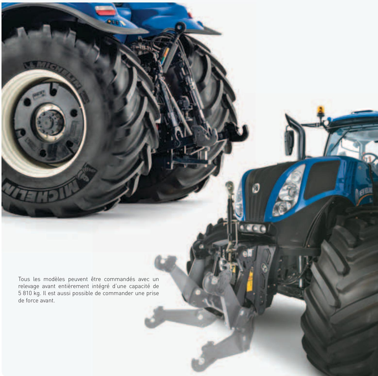
Tous les modèles peuvent être commandés avec un relevage avant entièrement intégré d'une capacité de 5 810 kg. Il est aussi possible de commander une prise de force avant.
