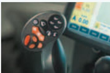
Les boutons souples sont rétroéclairés, ce qui facilite la sélection des commandes dans l'obscurité.
