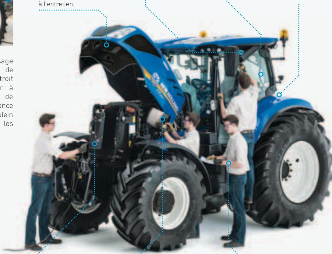
Le système de refroidissement s'ouvre vers l'avant pour un nettoyage plus rapide et plus facile.
