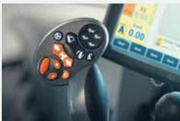
Les boutons souples bénéficient du rétro-éclairage qui facilite la sélection des commandes dans l'obscurité.
