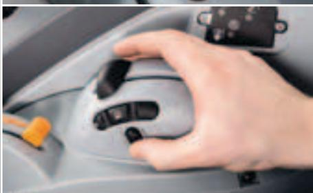
La souris de commande du relevage électronique place les contrôles d'effort et de profondeur au creux de votre main.
