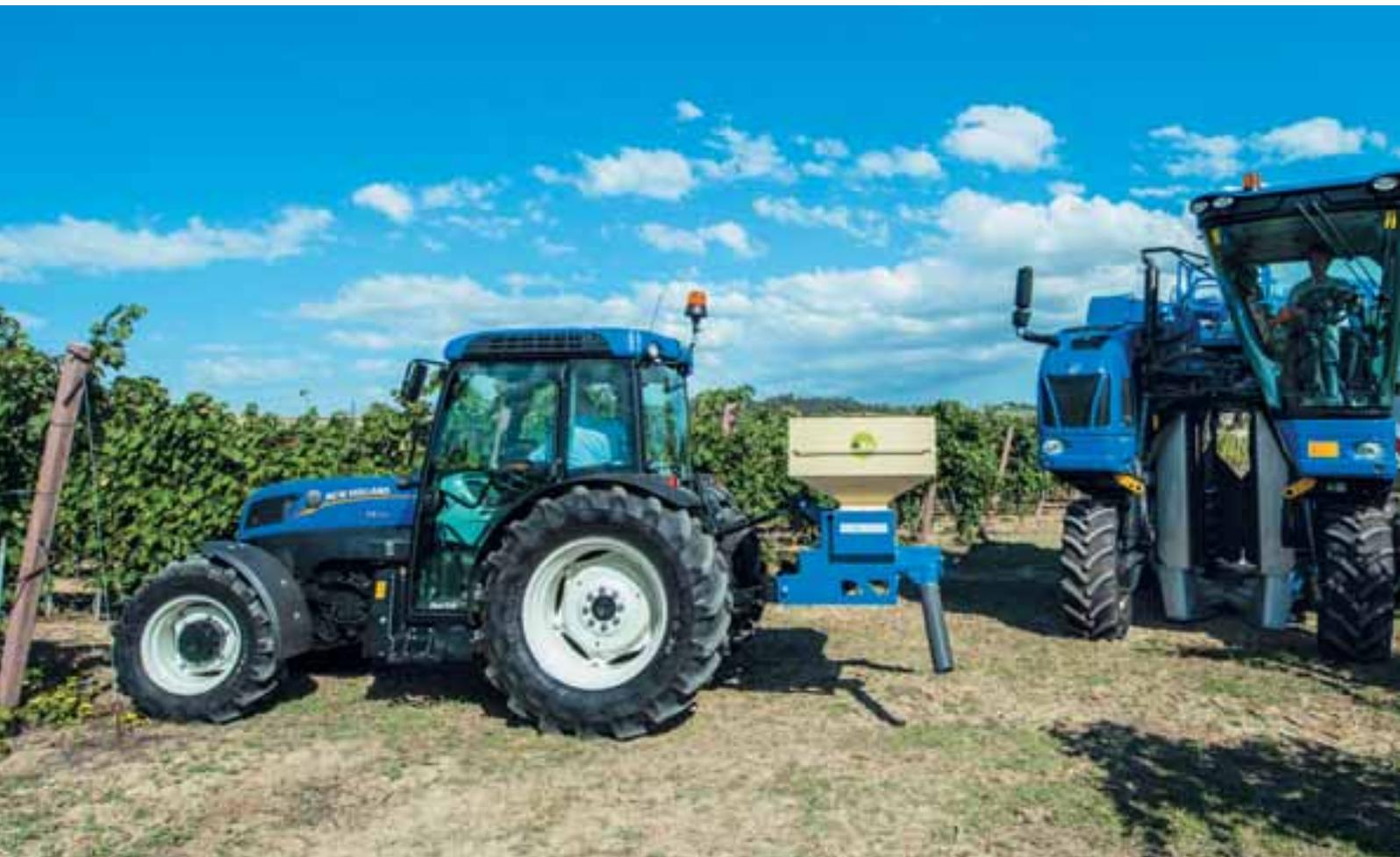
La construction modulaire des tracteurs T4F/N/V permet à New Holland de proposer une large gamme de spécifications répondant exactement à votre besoin spécifique. Le débit hydraulique standard de tous les modèles est de 64 litres/min. **T4F/N/V. Fabriqués selon vos spécifications.**
