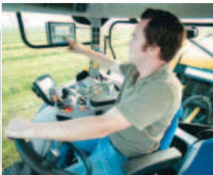
Sur les modèles 135 Ultra, un inverseur hydraulique est installé et commandé depuis le moniteur, en cabine. S'ils sont engagés, les couteaux sont automatiquement rétractés et l'entraînement du rotor ameneur et du ramasseur est inversé. Ceci permet d'éliminer un bourrage sans que l'utilisateur ne quitte la cabine du tracteur.
