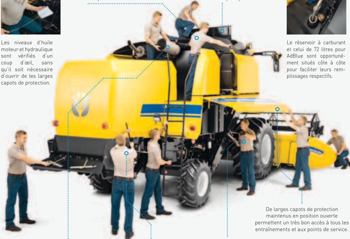
Le filtre à air est facilement accessible depuis la plate-forme du compartiment moteur.
