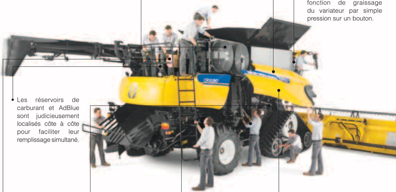
Les réservoirs de carburant et AdBlue sont judicieusement localisés côte à côte pour faciliter leur remplissage simultané.
