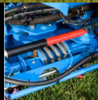
Anti-fouettement mécanique indépendant avec amortisseur
