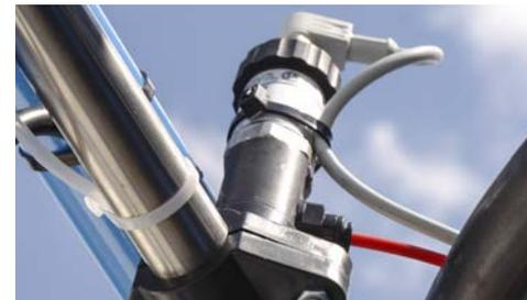
Le capteur de pression (information ou régulation) permet l'affichage de la pression sur l'écran du REGULOR 6 *plus* ou assure la régulation de la pulvérisation.
