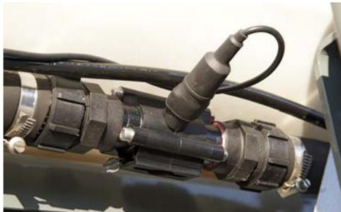
Base de la régulation, le débitmètre mesure la quantité réelle de bouillie envoyée à la rampe.
