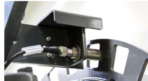
Le capteur de vitesse est fixé face à un disque 24 trous pour plus de précision. Ce disque est solidaire du moyeu pour faciliter les changements de pneumatiques. L'info vitesse peut également être donnée par l'antenne GPS si présente.
