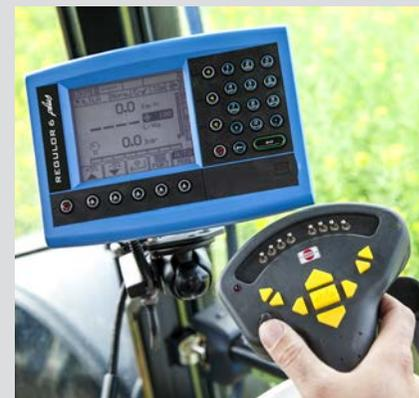
HARDI-EVRARD propose un dispositif de dilution du fond de cuve qui apporte confort et efficacité lors des rinçages. L'opérateur n'a plus besoin de descendre de la cabine pour manipuler les vannes de mise en œuvre car le dispositif est directement commandé depuis les menus du boîtier REGULOR 6 plus. Dans ce cas, la vanne d'agitation est également à commande électrique.
