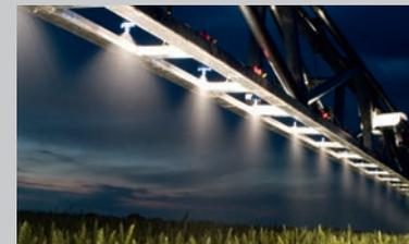
Eclairage de rampe halogène ou Led
