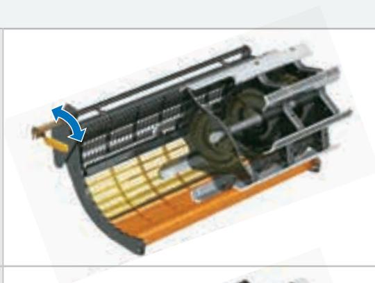
Batteur standard et contre-batteur à céréales à sections
