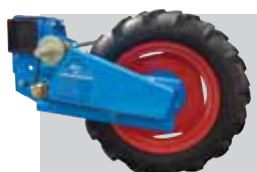
Bloc roue réglable avec roue 500 x 15 et boîte de distances intégrée Inter-rang minimum (1) : 43 cm Débattement : 25 cm
