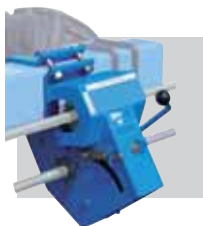
Boîte de distances centrale Inter-rang minimum (1) : 33 cm
