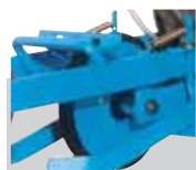
Roulette intermédiaire à bandage souple autonettoyant (Incompatible avec éléments MS D)
