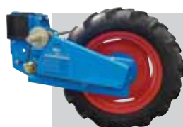
Boîte de distances combinée au bloc roue Inter-rang minimum (1) : 43 cm
