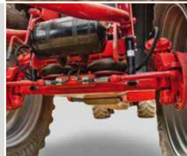
Garde au sol élevée et carénage lisse avec essieu suspendu, suspension à coussin d'air en option
