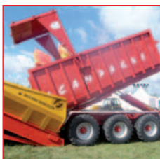
Caisson avec porte hydraulique
