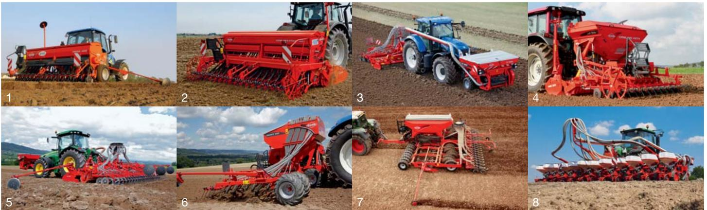
1. mécaniques portés 2. mécaniques intégrés 3. avec trémie frontale
