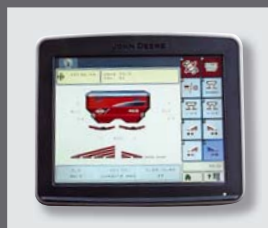
Terminal John Deere Greenstar 2630 avec gestion des sections
