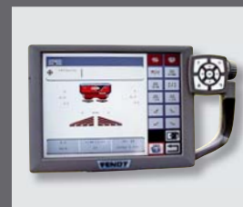
Terminal Fendt Vario avec gestion des sections
