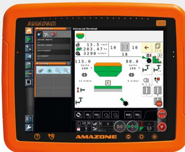
En plus de la coupure de tronçons GPS-Switch pro, un guidage manuel haute performance est également installé en standard avec GPS-Track pro. Les extensions de GPS-Track pro permettent d'obtenir un auto-guidage automatique.
