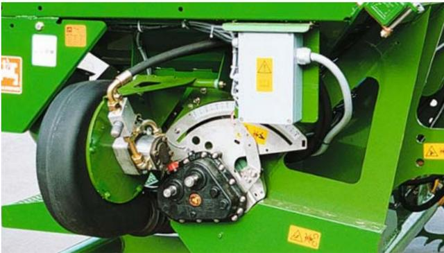
Un moteur hydraulique puissant entraîne la turbine pour l'alimentation de la semence. Les tracteurs modernes disposent d'un nombre suffisant de distributeurs hydrauliques qui fournissent un flux d'huile constant, quel que soit le régime moteur et satisfont donc aux conditions pour l'entraînement hydraulique.
