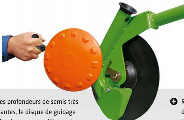
⊕ Pour des profondeurs de semis très importantes, le disque de guidage en profondeur est complètement retiré en une seule manipulation.
