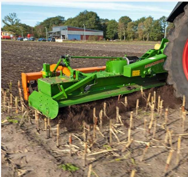
⊕ « Nous avons été impressionnés par le fonctionnement régulier des 2 x 10 porte-dents. En effet, au lieu d'être décalés par paire à un angle de 90° les uns par rapport aux autres, ils sont positionnés en spirale. »
