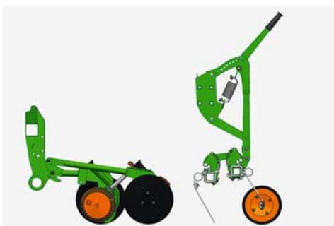
TassAprès® au travail : le recouvreur à dents fuyantes recouvre la semence avec de la terre qui est rappuyée par le recouvreur à roulettes.
